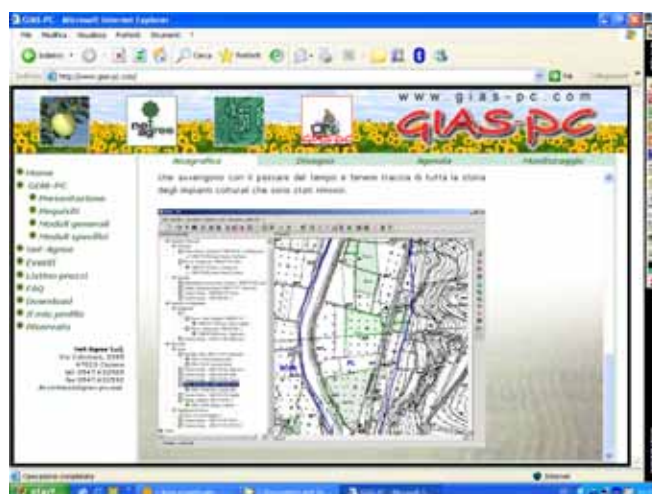
Fig.1 - GIAS: Sistema per l'assistenza tecnica aziendale realizzato dall'Assessorato Agricoltura dell'Emilia-Romagna. Il sistema si basa sull'uso di un personal computer aziendale con collegamento alle banche dati regionali. L'irrigazione viene stimata utilizzando un modello di bilancio idrico, la carta regionale dei suoli e i dati meteorologici forniti da Arpa-Sim.
