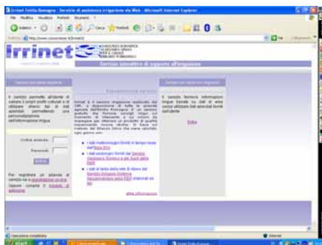
Fig. 2 - Irrinet: Sistema per l'assistenza irrigua sviluppato dal Consorzio di Bonifica di 2° Grado per il Canale Emiliano-Romagnolo. Il bilancio idrico aziendale viene aggiornato dal server centrale situato presso il consorzio. Sistemi simili sono disponibili per diverse regioni italiane.
