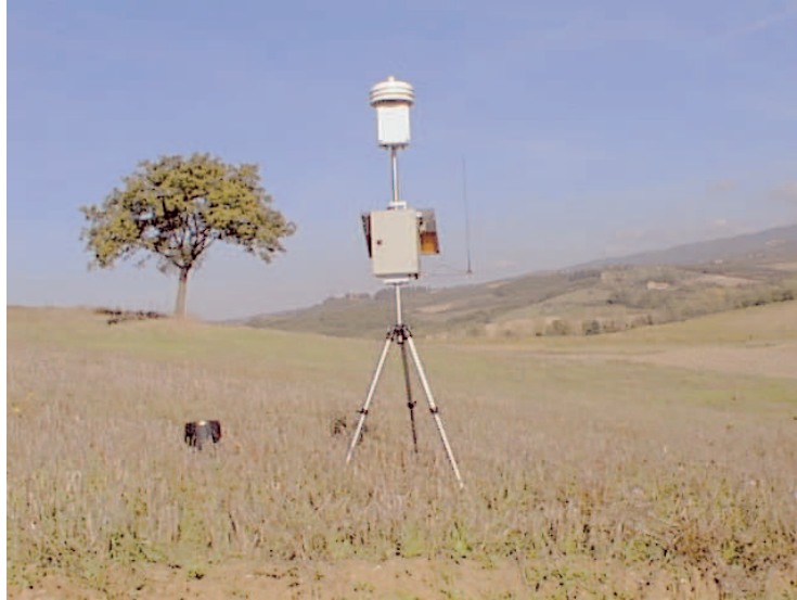
Figura 1 - Stazione meteorologica completa di sensori e acquirente
